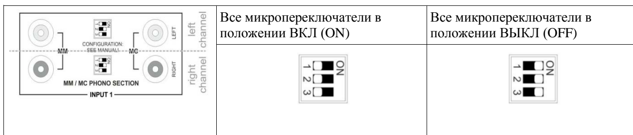
Рис. 6. Микропереключатели набора параметров фонокорректора
